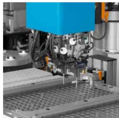
Die Abbildungen zeigen einen Klassifizierungsautomaten zum Aus-sortieren eines Aussendurchmessers. Mit Hilfe eines Doppelmess-Stativs wird die Taktzeit halbiert. So können in einem Arbeitsschritt zwei Teile gleichzeitig gemessen werden. Die Messtechnik basiert auf dem Scanning-Prinzip, bei dem ein Luftmessring über den zylindrischen Teil des Werkstückes fährt und etwa 200 Punkte misst.
