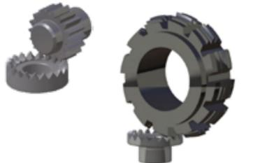
**Disk-Type Gear Milling Cutters**
