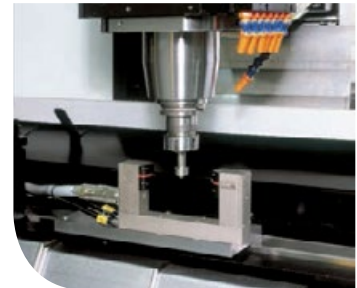
Taratura utensili laser Laser tools setting device
